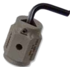
内六角转接头 编码 内六角尺寸<mm> A38940 2.5 - 5.0 A38950 6.0 - 8.0
